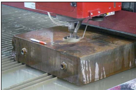
Arbetsstycke från Tidaholm Industries, 150mm stål, fixturdelar till fordonsindustri
