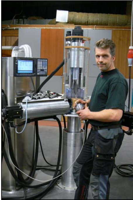
Tidaholm Industries, Klas Henriksson framför egenutvecklad maskin för montering av knutkors till tung fordonsindustri. Styrssystem Mitsubishi M70.
